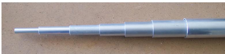
Poggiate il semidipolo su un piano, ed iniziate a sfilare il diametro minore, Fate combaciare il foro del tubo interno con quello del tubo esterno. Il fissaggio degli elementi avviene inserendo il bullone dal lato del foro maggiore in modo che la testa cilindrica del perno risulti ben incassata e poggi sul tubo interno fig.2.
